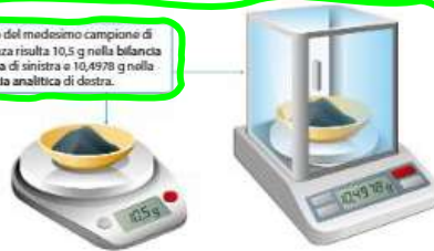
Figura 1 La pesata dello stesso campione con due diverse bilance.
