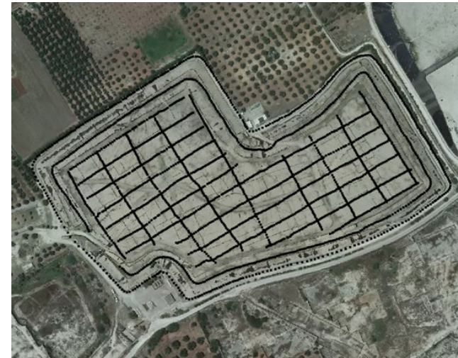
Ubicazione profili EMI sul corpo discarica ( \approx 9 ha)
