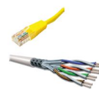
Fig. 3 Il connettore RJ45 (sopra) e i cavi intrecciati del doppino TP (sotto).
